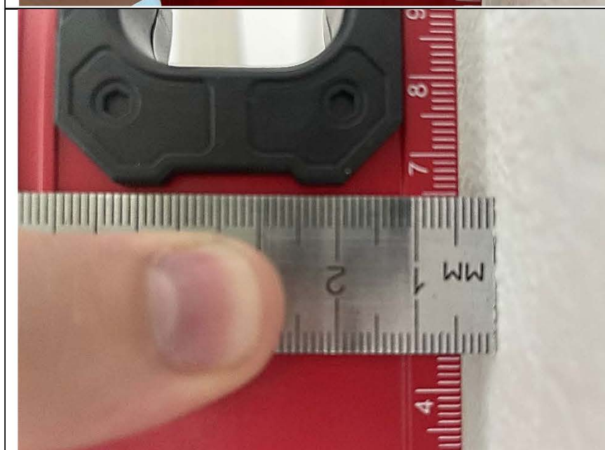
Фото №9. Измерение уровня стен в спальня в квартире.
